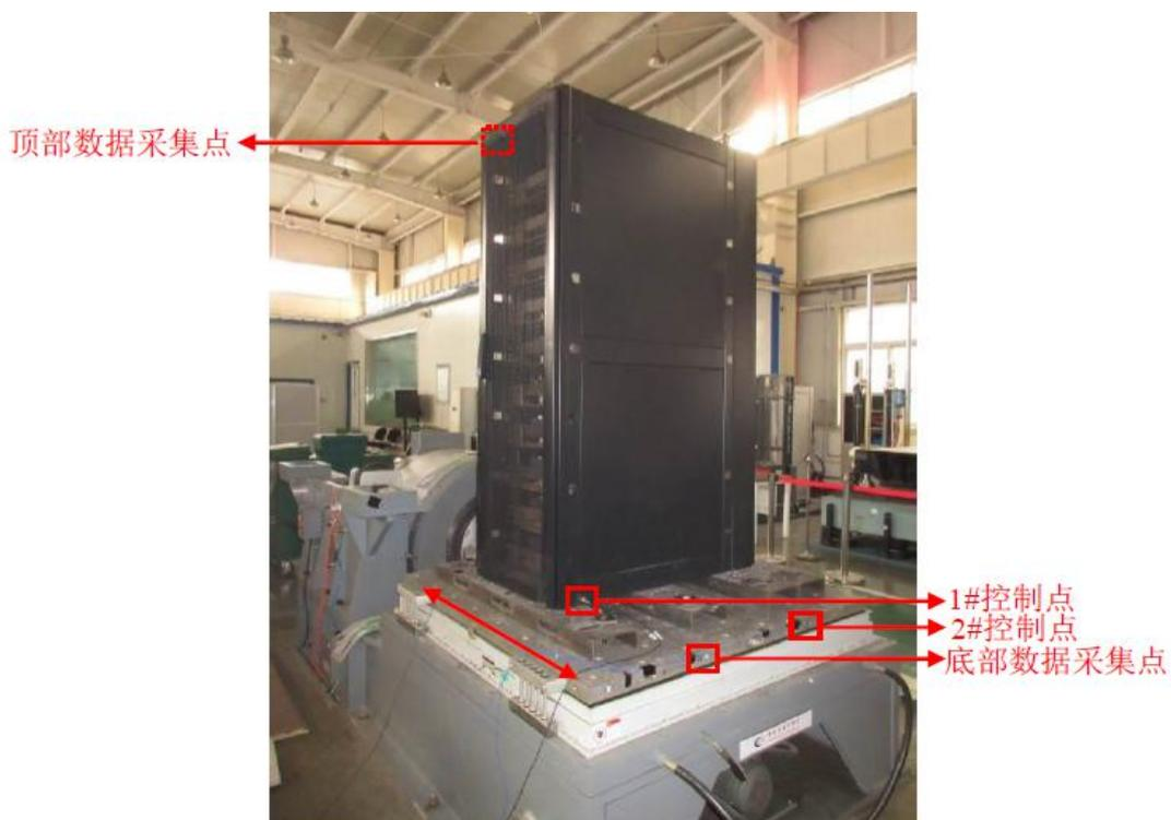
图 5：机柜动态测试现场照片
